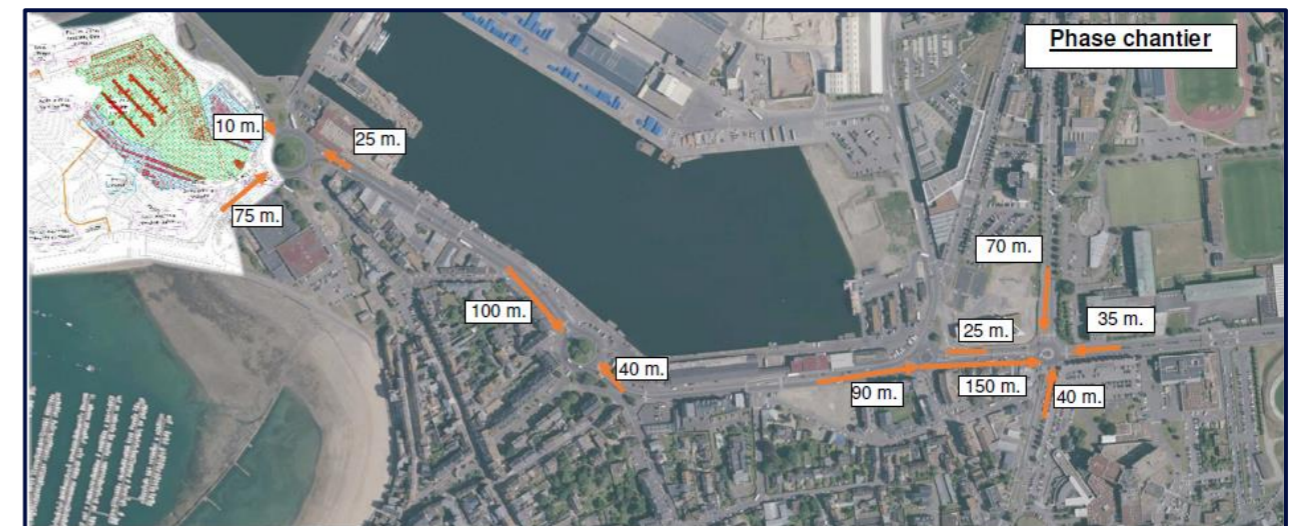
Figure 24 : Cartographie des longueurs maximales de congestion en phase travaux (Source : Modélisation trafic, phase 2, EMTIS, 2023)
