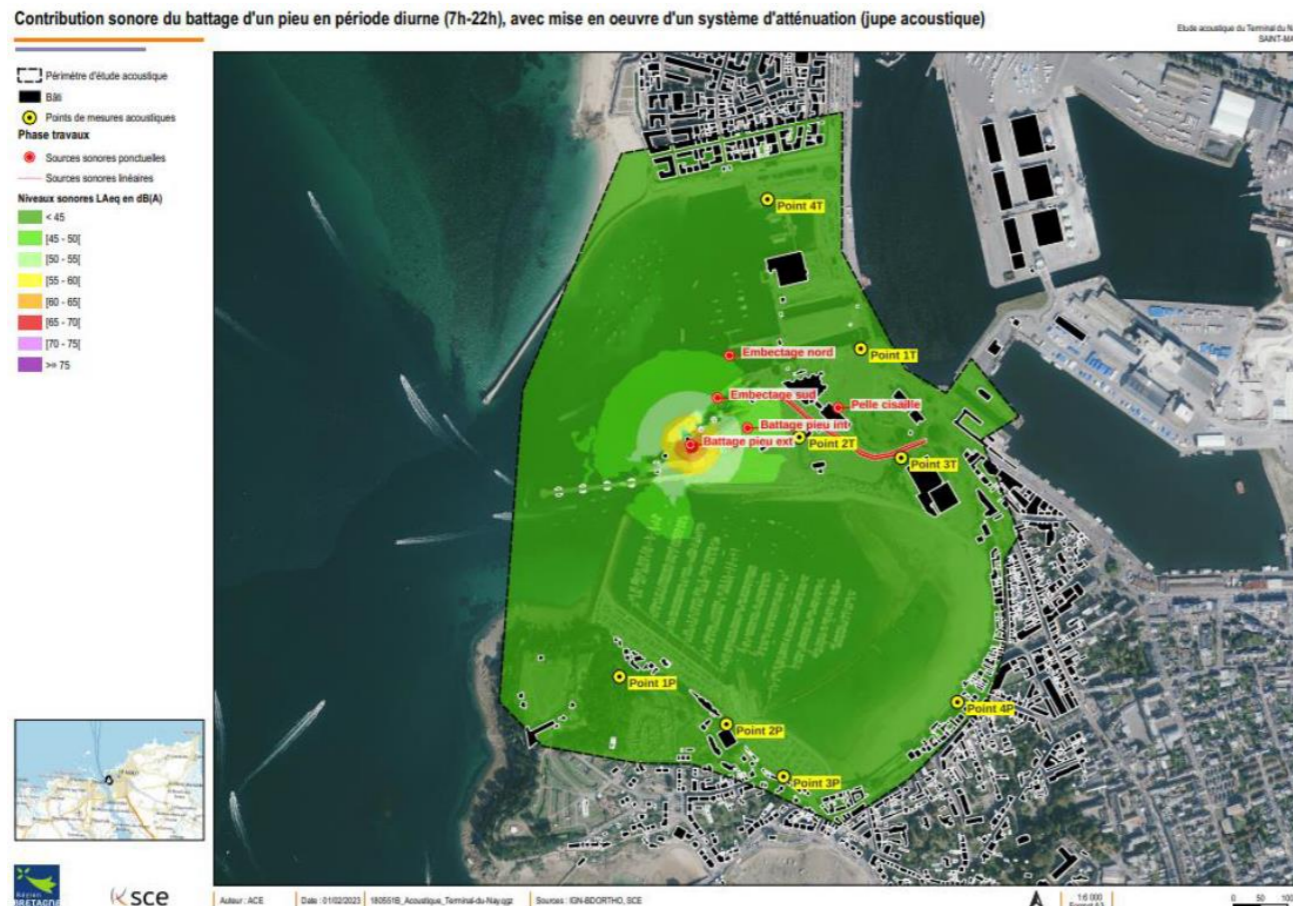
Figure 35 : Contribution sonore de battage d'un pieu en période diurne avec mise en œuvre d'un système d'atténuation (Source : Etude Acoustique Terrestre Phase 2, SCE, Février 2023)
